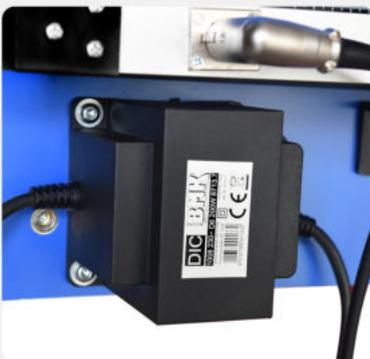
Montieren Sie den **Transformator (8)** mittels der **4 Flachkopfschrauben M6x20mm (H)** und der **4 Unterlegscheiben** an die **Vorderseite des unteren Bereiches des Schneidebrettes (G)**. Stecken Sie hierzu die **Flachkopfschrauben (H)** durch die **Unterlegscheiben** und anschließend durch die **Anschraubbohrungen des Transformators (8)** und schrauben Sie diese in die **Gewindebuchsen des Schneidebrettes (G)**. Stecken Sie anschließend den **XLR Stecker** in die **XLR Einbaubuchse (14)**.
